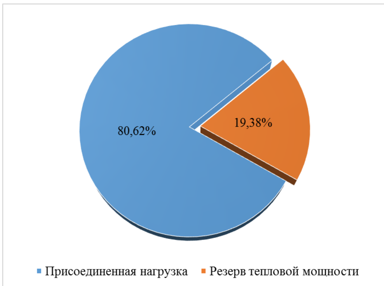
Рисунок 8 –Резерв тепловой мощности нетто ТЭЦ
