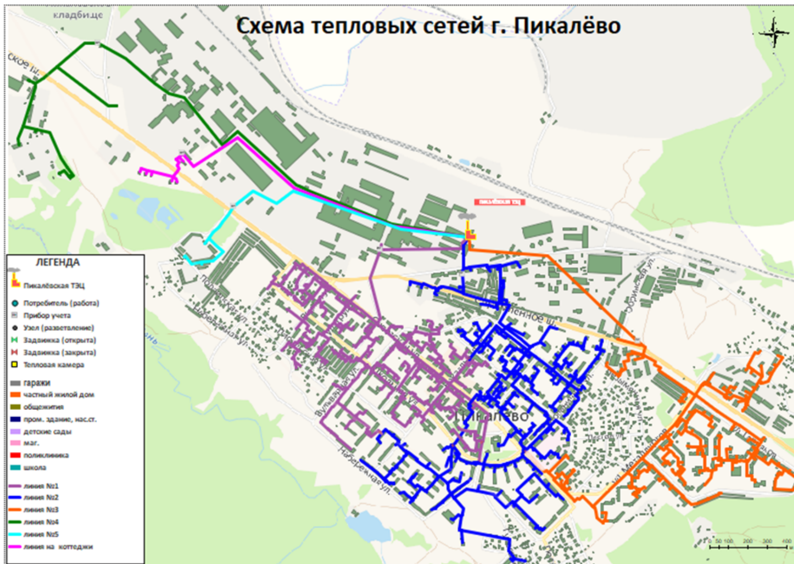
Рисунок 3. Схема централизованного теплоснабжения
