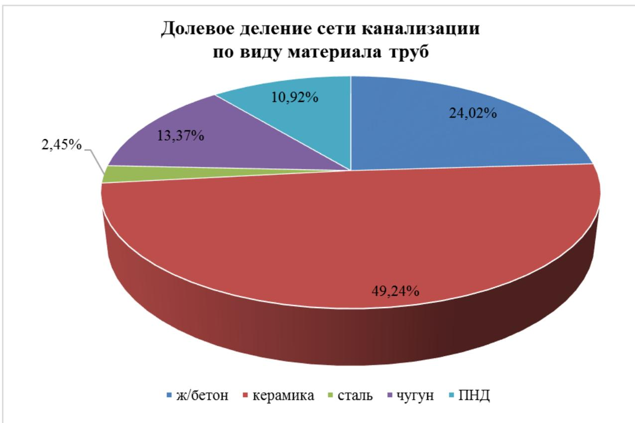
**Рисунок 27 - Долевое деление общей протяженности сети системы водоотведения по виду материала трубопроводов**
